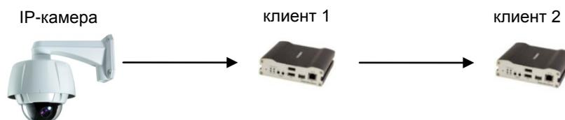
Видео и аудио данные могут быть ретранслированы от одного клиента другому. Такой режим используется в случае ограниченной ширины канала, связывающего IP-камеру с центром видеонаблюдения (клиент1) – он позволяет ретранслировать данные от этой камеры множеству другим клиентам, не используя ограниченный канал связи.
