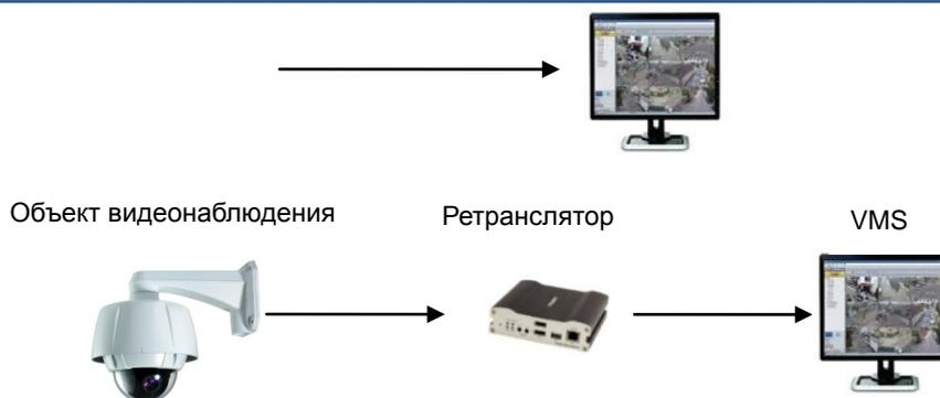
ПО VMS (Video Management System) – это программа на базе ОС семейства Microsoft Windows, которая позволяет осуществлять мониторинг, контроль, настройку и запись событий, видео и аудио данных в реальном времени нескольких IP-камер или видеосерверов. Для получения более подробной информации, прочтите инструкцию по эксплуатации ПО VMS.
