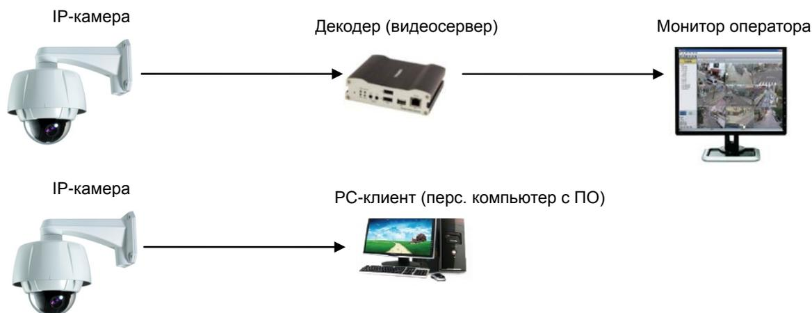
IP-камера установлена на объекте видеонаблюдения и передаёт видеоданные. Персональный компьютер с установленным ПО или декодер установлены в центре видеонаблюдения и принимают и отображают видеоданные на аналоговом мониторе оператора. Аудиоданные и данные телеметрии передаются в обоих направлениях.
